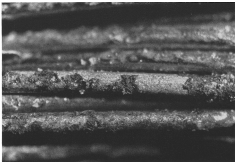
Abb. 5. Kupferfäden einer Litze mit dunklen Oxydationsprodukten, hellen Epithelauflagerungen und folienartig abgeschälten Fehlstellen. Unruhige Oberfläche bei Fehlen von Ziehspuren. M 40 : 1
